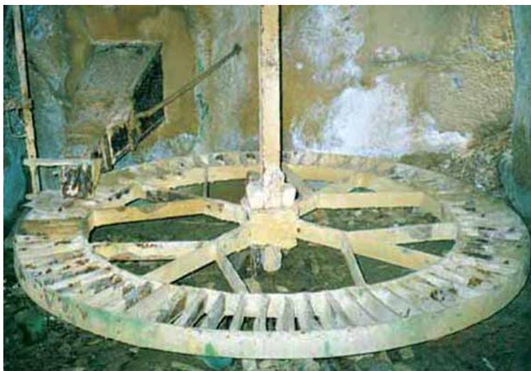
*Fig. 49 - Tipica “cammara da rota” con guarraffo e ruota idraulica. A sinistra può notarsi il dispositivo che consentiva la rotazione del beccuccio del guarraffo, azionato da una leva comandata dal piano della molitura. L'immagine è di repertorio e non si riferisce al mulino di Carrabba.*
